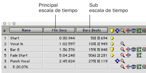
Contadores principal y secundario en la ventana Memory Locations
