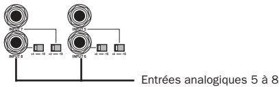
Entrées analogiques (panneau arrière)
