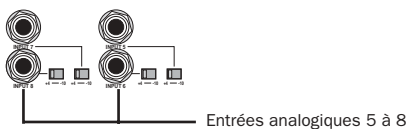
Quatre entrées analogiques (panneau arrière)
