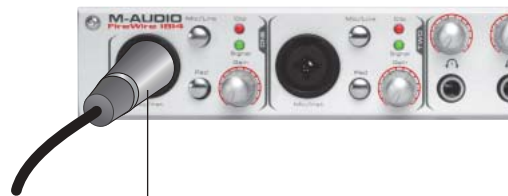
Branchement du connecteur XLR à l'entrée micro/instrument d'une FireWire 1814
