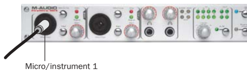
Branchement du câble de la guitare à l'entrée micro/instrument d'une FireWire 1814
